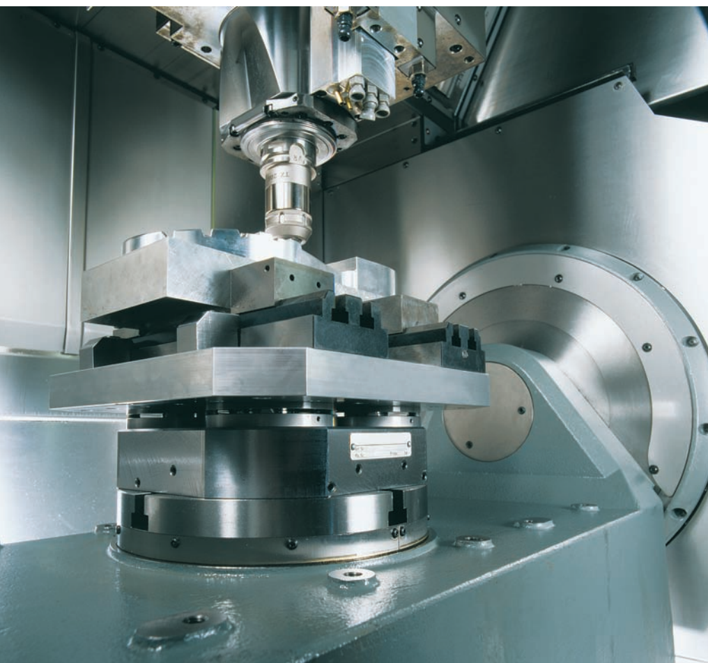
Прецизионный поворотный кантуемый стол; максимальная производительность достигнута при помощи решений INA и FAG
