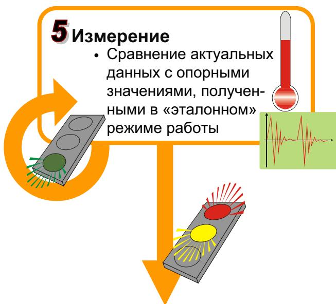
В течение 16 секунд будет проводиться измерение. Измеренные значения сравниваются с опорными и пороговыми значениями (см. пример на оборотной стороне). Состояние отображается посредством светодиодов.
