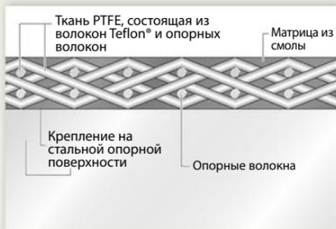
ELGOGLIDE® представляет собой ткань PTFE, состоящую из волокон Teflon® и опорных волокон, помещённых в смоляную матрицу, и закреплённую на стальной опорной поверхности
