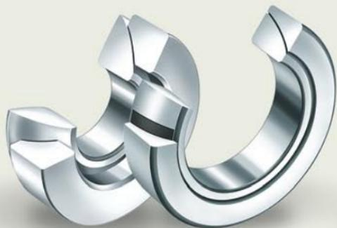
Радиально-упорные шарнирные подшипники (Ø 25 - Ø 200 мм) для восприятия комбинированных нагрузок; упорные шарнирные подшипники (Ø 10 - Ø 360 мм) для осевых нагрузок могут устанавливаться совместно с радиальными шарнирными подшипниками
